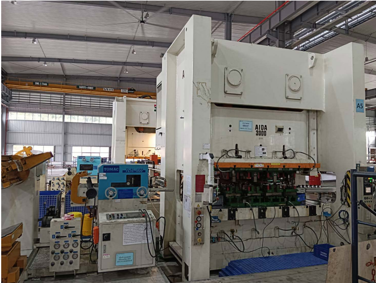
Installation 300 Ton Aida Press Model : NS2-3000, Total Weight : 45 Ton
