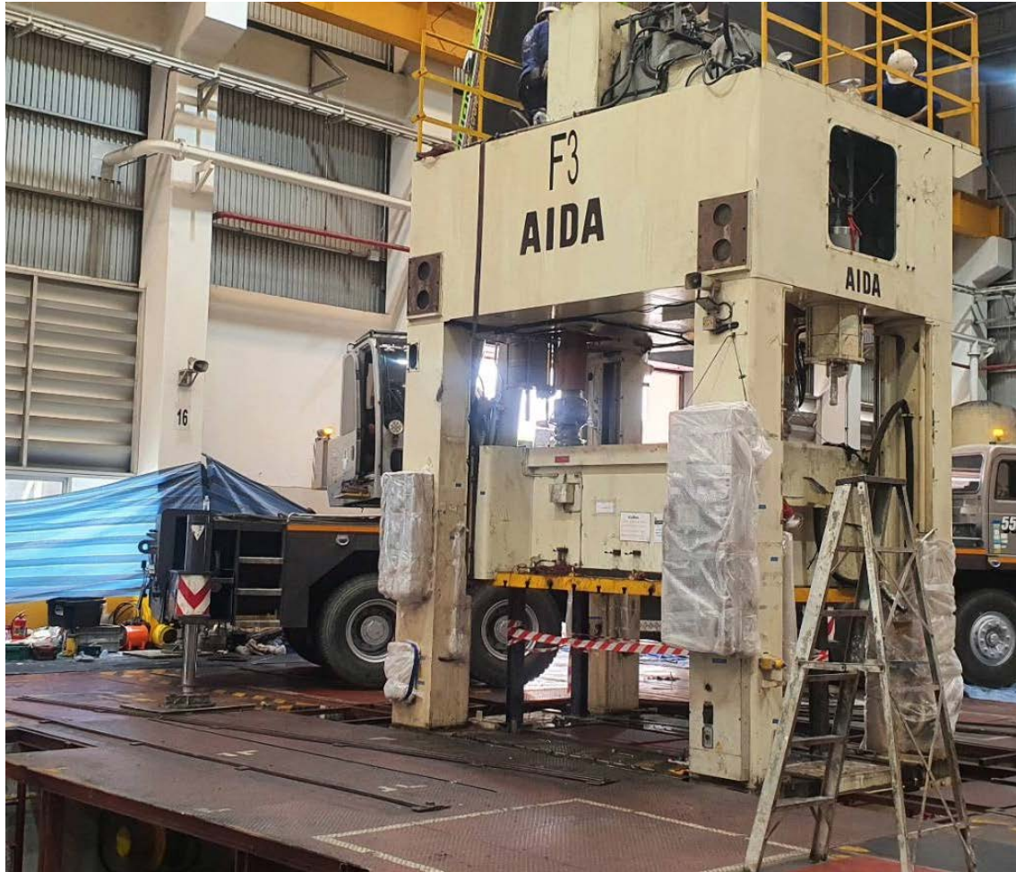
Disassembly 300 Ton Aida Press Model : SMX-3000. Total Weight : 64 Ton
