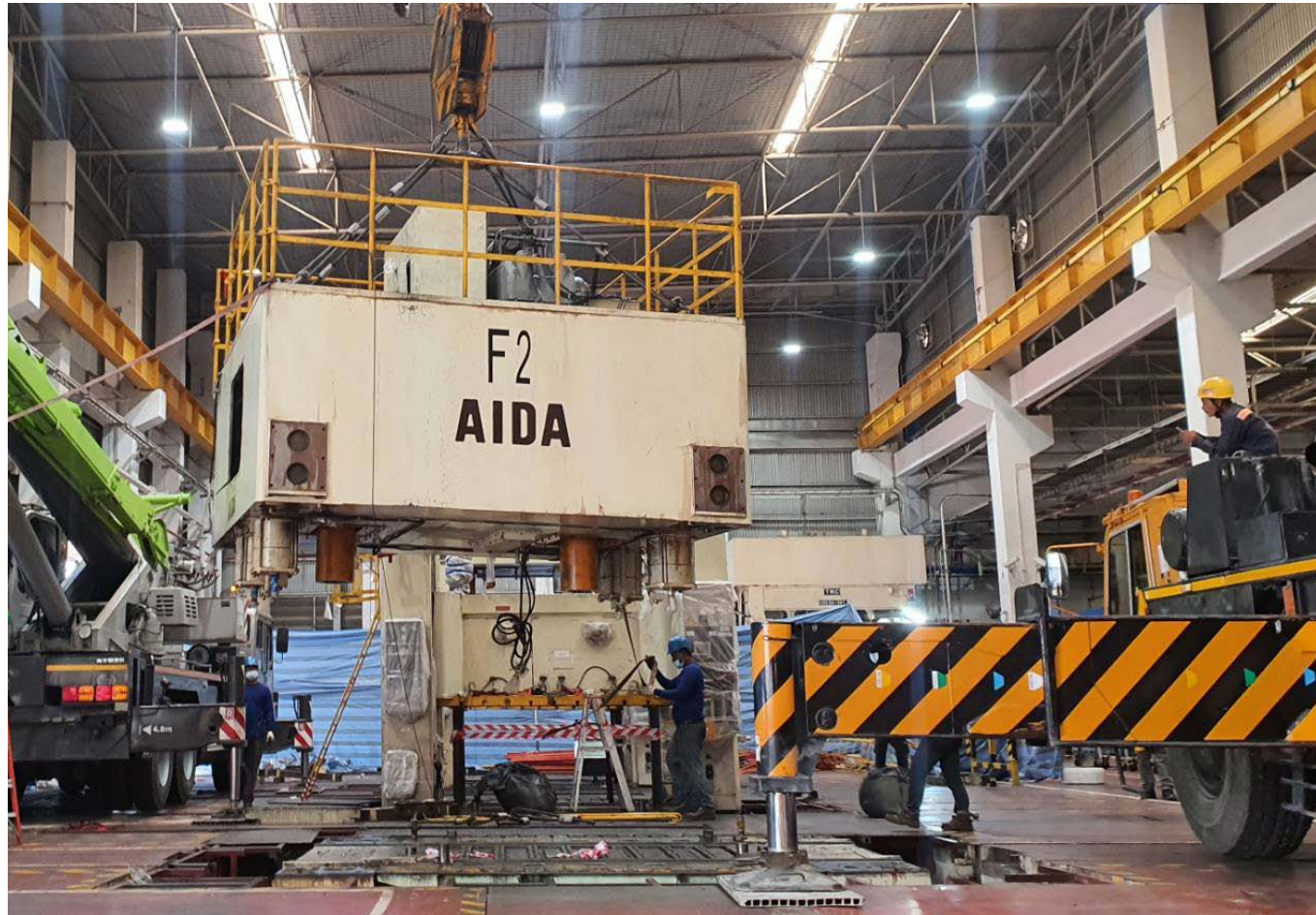
Disassembly 400 Ton Aida Press Model : SMX-4000. Total Weight : 82 Ton
