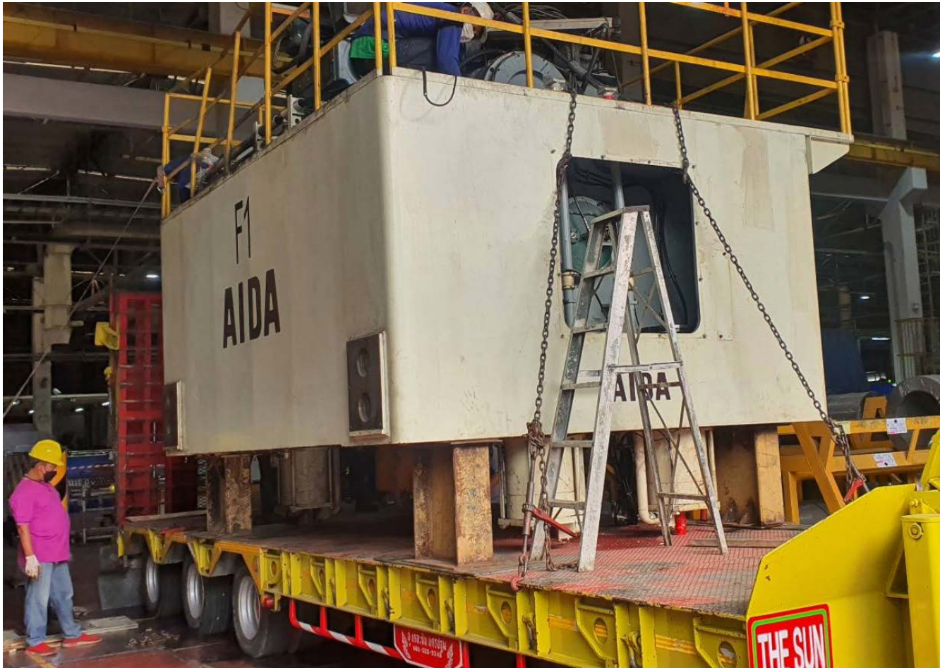
Disassembly 600 Ton Aida Press Model : SMX-6000. Total Weight : 136 Ton
