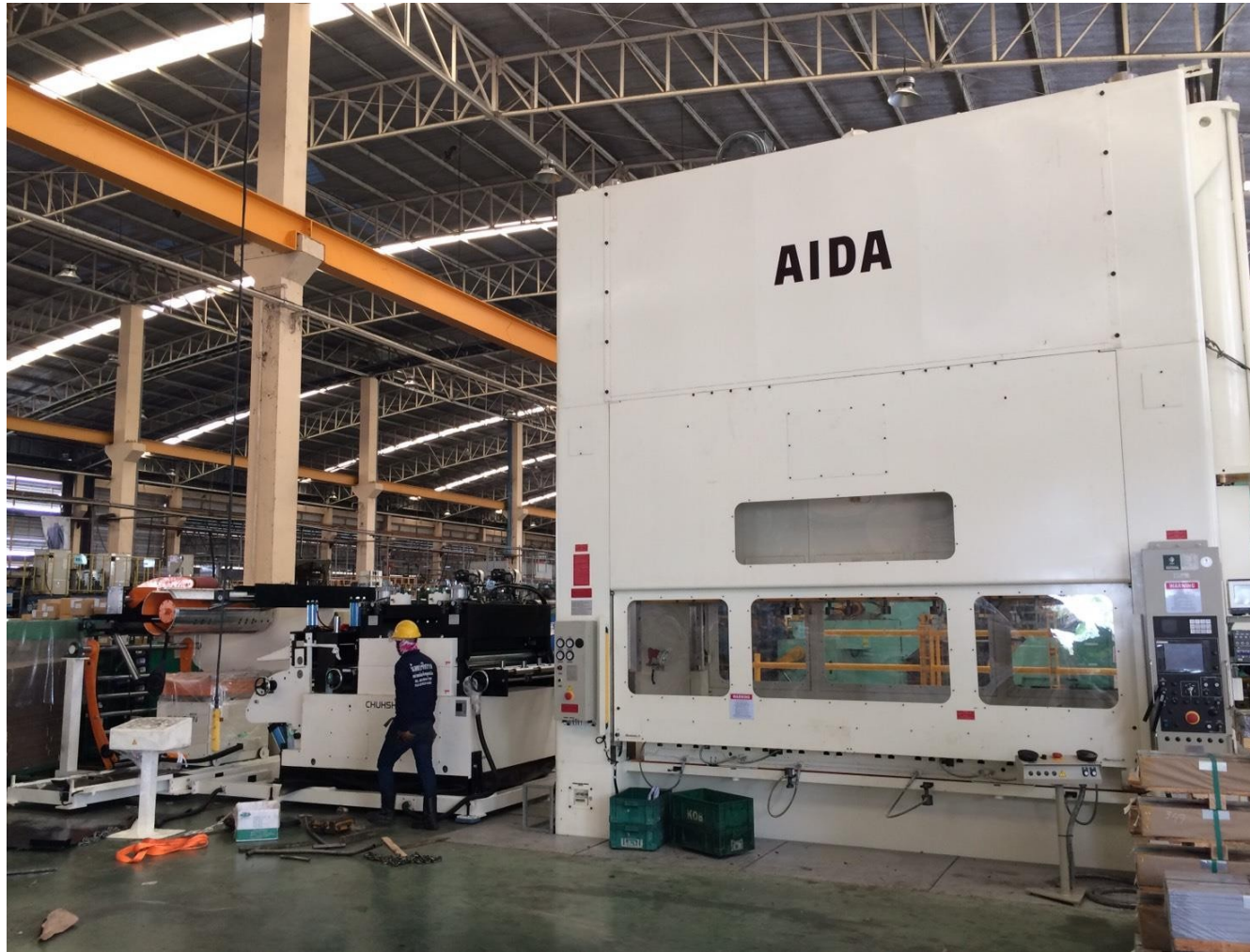
630 Ton Press Model : MCX-6300 + Feeder Bolster : 3650 x 1600 mm
